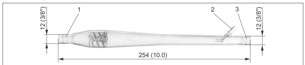
消泡装置示意图（单位：mm (inch)）
